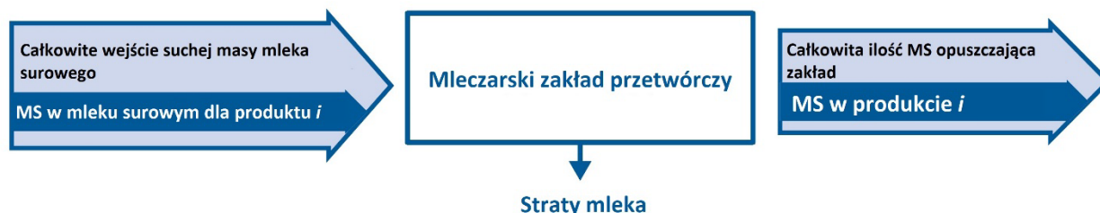
Rys. 8. Uproszczona ilustracja równowagi mleka w mleczarskim zakładzie przetwórczym
